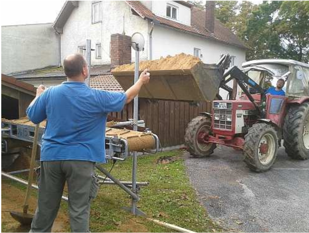
Der Sand wurde mit einem Förderband nach unten an den Stand transportiert ...
